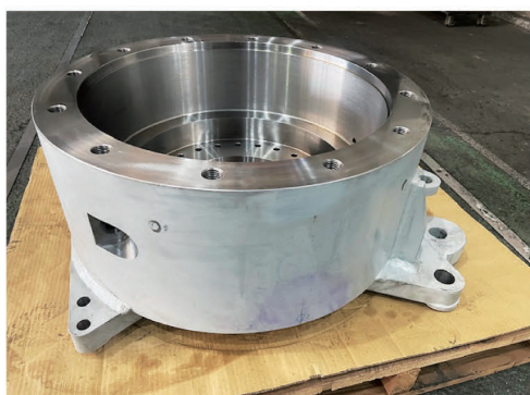
アウトプットハウジング (溶接構造、重量約800kg)
