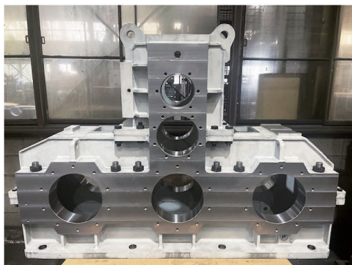
減速機用ハウジング (溶接構造、重量約2,000kg)
